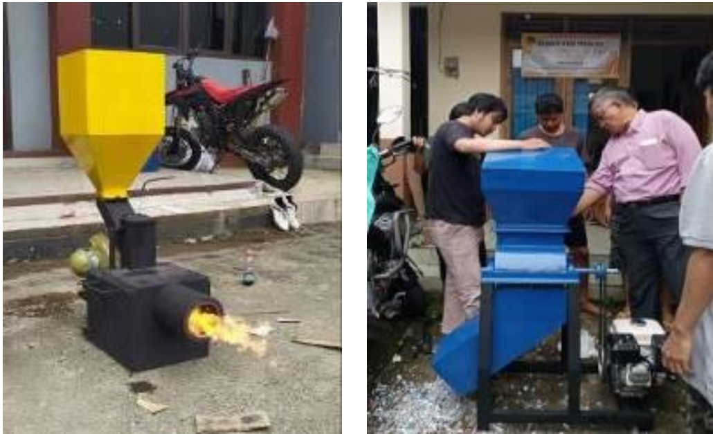
Gambar 7.18. (a). Burner pembakar berbahan bakar wood pellet dan (b). Mesin pencacah plastic TTG mesin pencuci asap ditunjukkan pada gambar 7.19.
