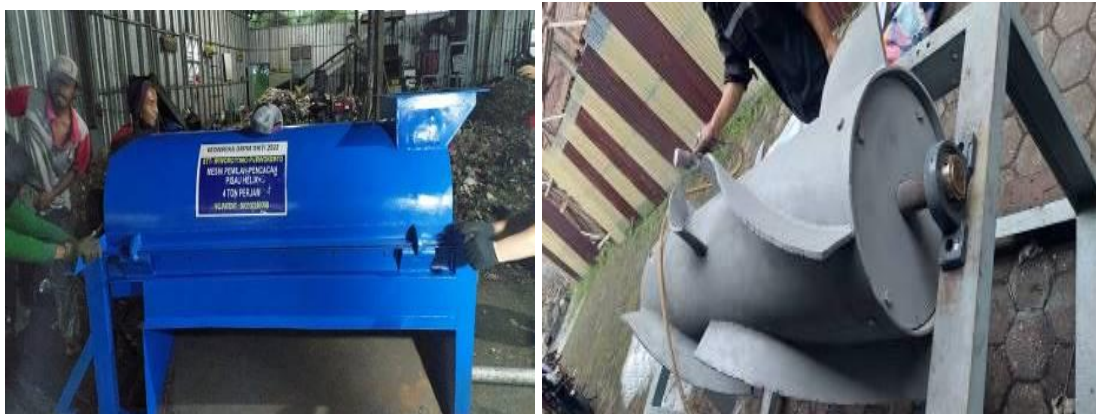
Gambar 7.17. TTG Mesin pemilah sampah 4 ton perjam dengan pisau helix
