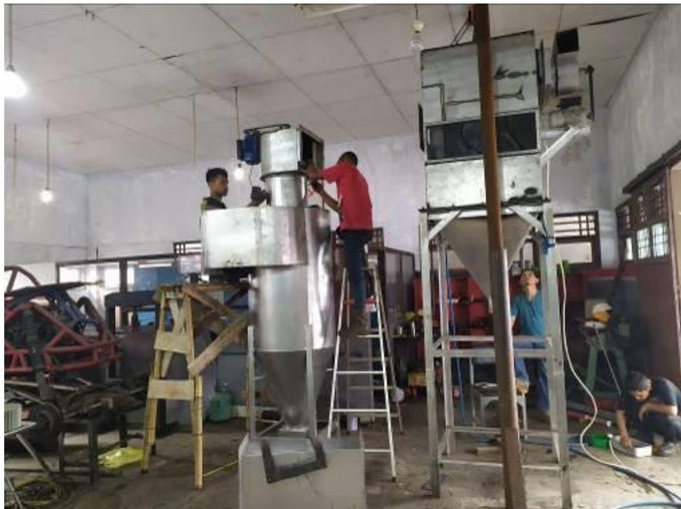
Gambar 7.19. TTG Mesin Pencuci Asap Wet Scruber Plat Harmonik TTG ini merupakan mesin pencuci asap yang bekerja dengan memanfaatkan tekanan gas pembakaran melalui pengaturan celah dengan plat yang bergerak harmonic untuk
