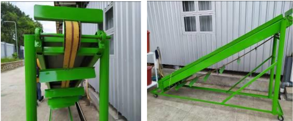
Gambar 3.8. Dokumentasi penyerahan alat conveyor untuk pengolahan sampah di Desa Rempoah Tahun 2020.
